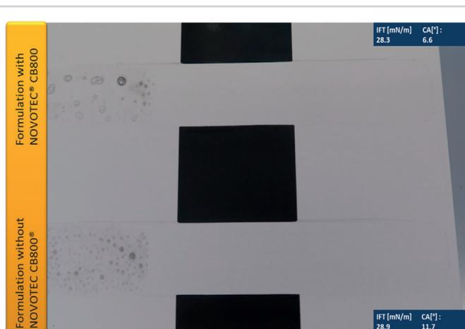
**Abb. 4** Eine Fliese wurde mit konzentriertem Reiniger mit/ohne NOVOTEC® CB800 vorgereinigt und mit dem jeweiligen Reiniger nach der Verschmutzung erneut gereinigt. Es zeigen sich nur marginale Verbesserungen auf der mit Protein vorbehandelten Seite.
