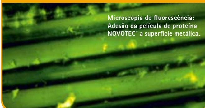
Microscopia de fluorescência: Adesão da película de proteína NOVOTEC® a superfície metálica.
