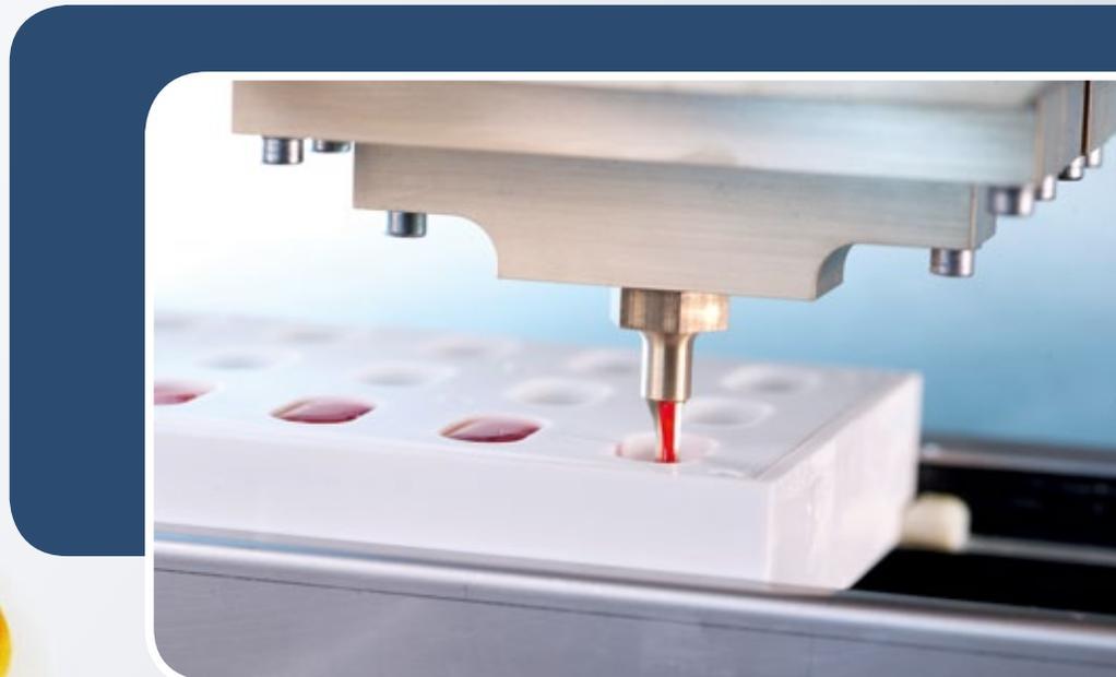
Saubere Produktion: FFP ermöglicht es, Fruchtgummis in wiederverwendbare Silikon- anstatt Stärkeformen zu gießen. Die Produkte lassen sich dadurch ohne Kontaminierung herstellen.
