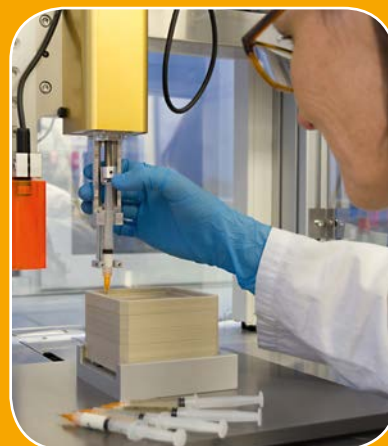
A impressora 3 D em ação. Nas seringas, diferentes formulações de biotinta (veja também a foto principal).
