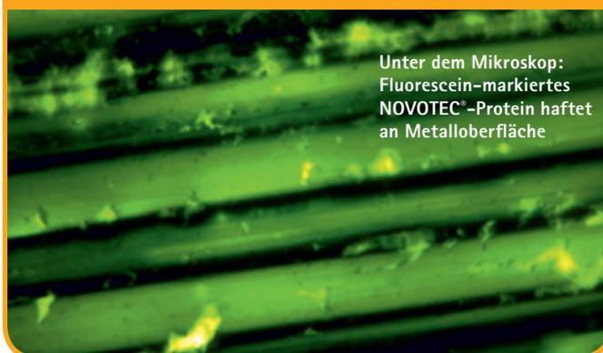
Unter dem Mikroskop: Fluorescein-markiertes NOVOTEC®-Protein haftet an Metalloberfläche
