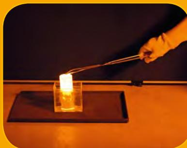
Teste de choque térmico de 1200 °C: maçarico na água.
