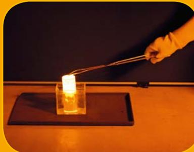
Ensayo de choque térmico, un soplete calentado a 1200 °C en agua.
