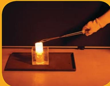
Thermoschocktest einer auf 1200 °C erhitzten Brennerdüse in Wasser.
