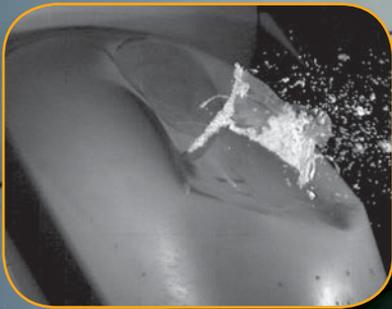
O DLR catapulta pássaros artificiais de gelatina com a ajuda de canhões de gás em direção a componentes de aeronaves – e determina desta forma se o material resiste a uma colisão com pássaros reais.
