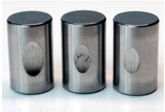
Drei Prüfrollen von Schmierstoff-Tests mit der Reibverschleißwaage (Reichert): links geschmiert mit Wasser, in der Mitte mit einem Standard-Kühlschmierstoff und rechts mit Novotec CL800 (jeweils fünf Prozent).
