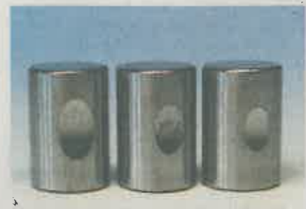
Verschleißtest: Links geschmiert mit Wasser, in der Mitte ein Standardmittel, rechts CL 800 (je 5 Prozent) Foto Hersteller
