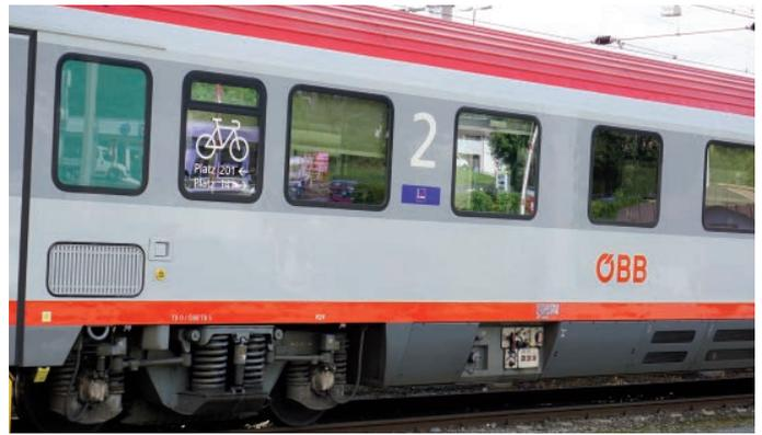
**BILD 3 & 4:** Glanz auf Fenstern und Lackflächen: Der Schutzfilm auf den ÖBB-Reisezugwagen lässt die Außenhaut „wie neu“ erscheinen
