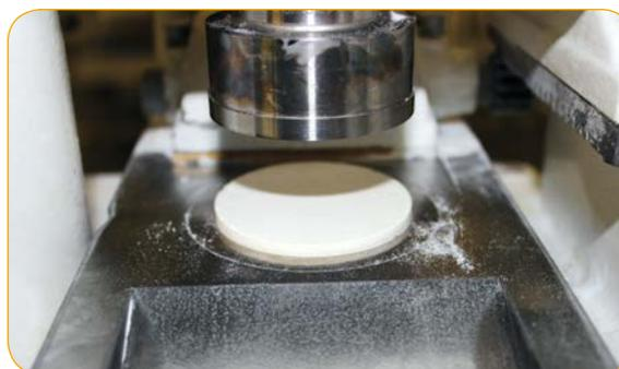
Os Peptídeos de Colágeno GELITA® usados na produção de comprimidos apresentam uma ótima performance devido a seu perfil granulométrico e sua alta densidade. Comprimidos com 99% de peptídeos de colágeno e 1% de lubrificante apresentaram perfil de dissolução e desintegração satisfatório.
